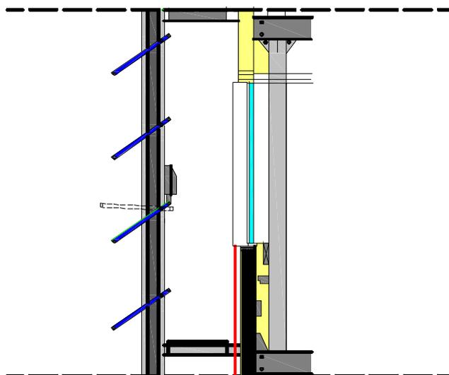
**Figura 20 – Schema costruttivo di un frangisole fotovoltaico**
