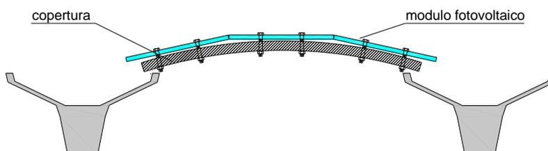
**Figura 11 – Schema esemplificativo di un'installazione idonea alla classificazione dell'impianto fotovoltaico nella categoria "su edifici"**
