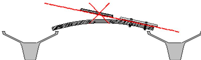
**Figura 13 – Schema esemplificativo di un’installazione non idonea alla classificazione dell’impianto fotovoltaico nella categoria “su edifici” – Motivazione: il modulo non è appoggiato alla superficie di copertura**
